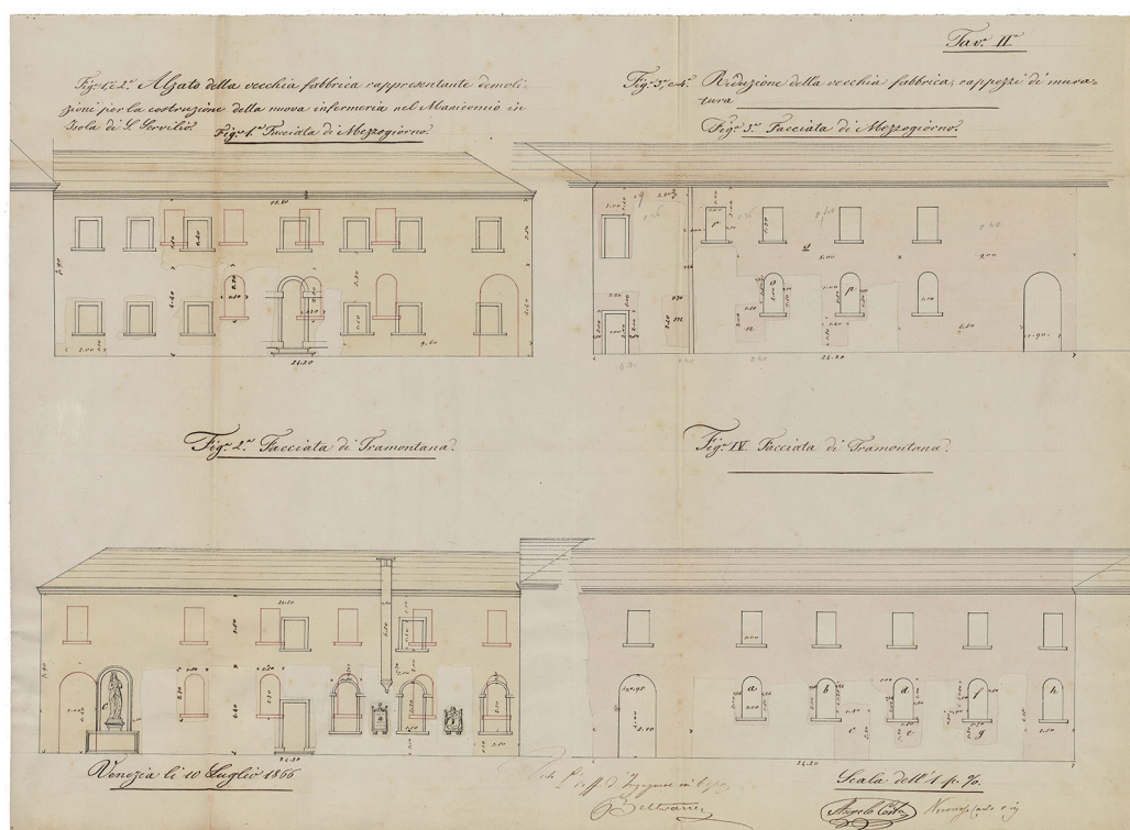
Fig. 3. Prospetti dell'edificio settecentesco trasformato in infermeria, con indicati i lavori effettuati, 1866 (ASVe, Ufficio del Genio Civile, Atti, b. 737, dis. 9).
